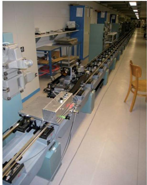
Abb. 13 | Längenkomparator der PTB
