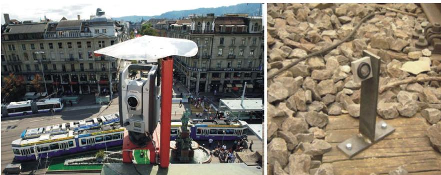
Abb. 8: Tachymeter am Bahnhofplatz / Messprisma im Gleisfeld
