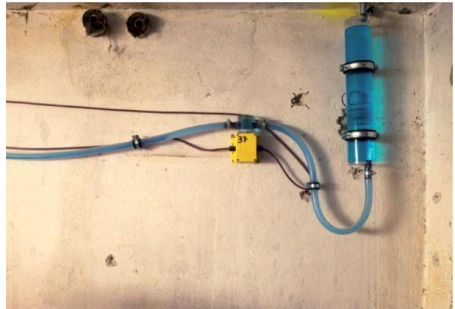
Abb. 9: Schlauchwaagensensor mit Ausgleichsgefäß
