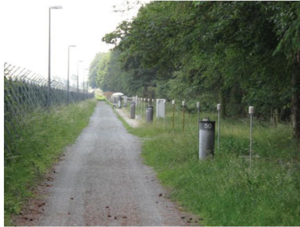
Abb. 2 | Übersicht der Kalibrierbasis; rechts neben den Pfeilern sind die Temperatursensoren in wettergeschützten Kapselungen zu erkennen
