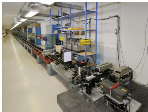
Abb. 1 | Ansicht des Längenkomparators
