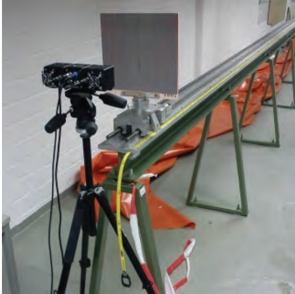
Abb. 5 | Messanordnung bei Untersuchungen auf der Komparatorstrecke
