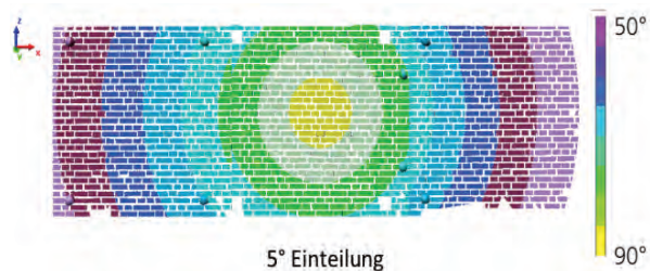
Abb. 7 | Einteilung der Sollfläche in Zonen gleichen Auftreffwinkels
