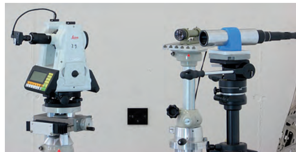
Abb. 12 | Messaufbau für die vollautomatische Erfassung der Langzeitstabilität von Stativen
