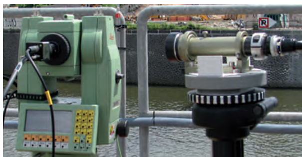
Abb. 2 | MoDiTa mit Kollimator als fixes Ziel für die Selbstkalibrierung im Felde
