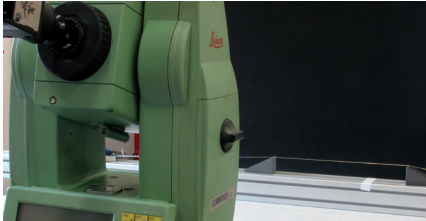
Abb. 6 | Erfassung der Schwingung einer Violinsaite mit der Okularkamera am Tachymeter Leica TCRA 1103
