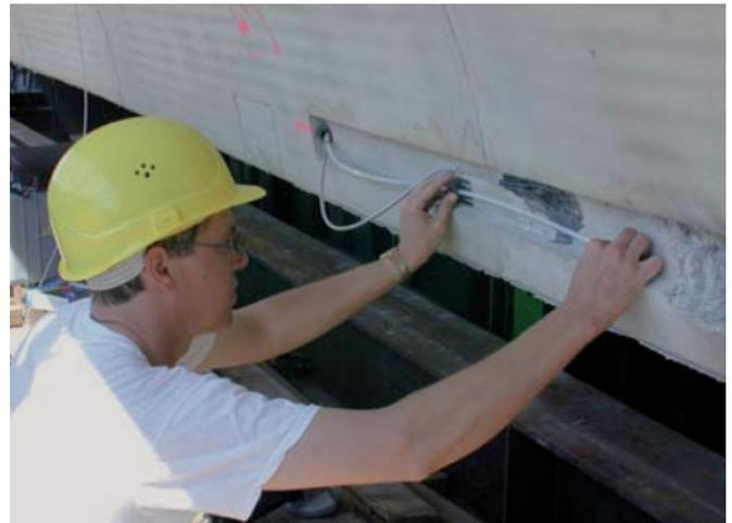
Abb. 1: Fixierung (Aufspannen) der Sensorfaser in einer oberflächennahen Aussparung (Foto: BAM)
