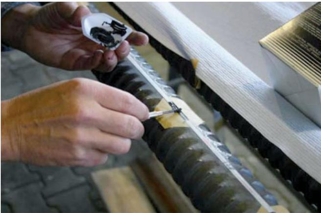
**Abb. 7: Direkt auf die Oberfläche applizierte optische Faser mit eingeschriebenem Bragg-Gitter als Dehnungssensor (Foto: BAM)**
