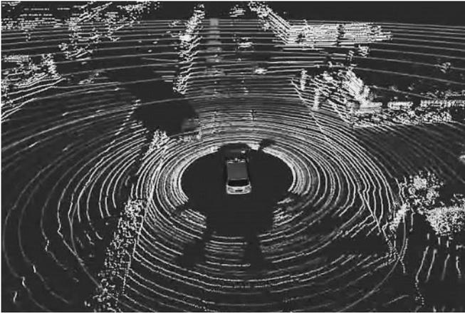
Abb. 7: Laserdaten zur Bestimmung der Objektkarte
