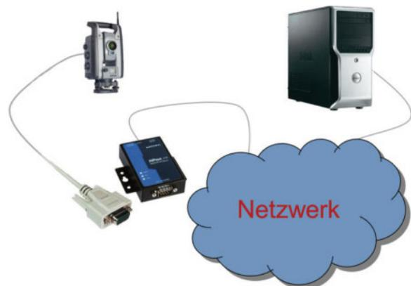
Abb. 3 | Netzwerkverbindung unter Verwendung eines Serial Device Servers der Firma MOXA
