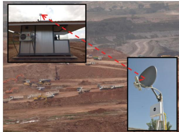
Abb. 4 | Installation eines WiFi-Transmitters mit Richtfunkantenne in einem Kupfertagebau in Thailand
