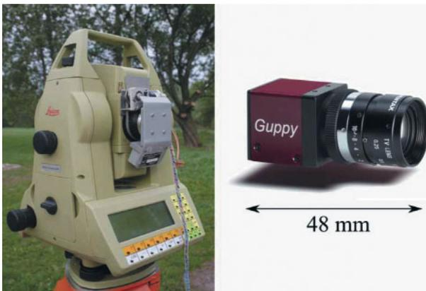
**Abb. 2** | Links: Leica TCA 2003 mit aufgesetzter Okularkamera und montiertem Schrittmotor, rechts: Basiskamera AVT Guppy F-80B /AVT 2009/
