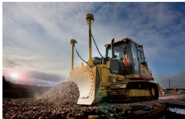
Abb. 1 | GCS900 Dual GNSS Maschinensteuerung auf Dozer
