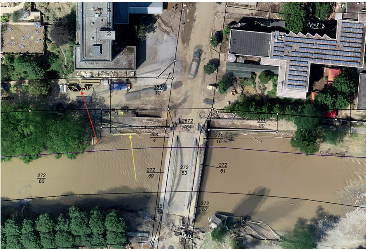
Abb. 6 | Orthofoto der Landgrafenbrücke mit hinterlegtem Kataster. Deutlich zu erkennen sind Einzelheiten, z.B. die freigelegte Gasleitung (gelb) oder die Lagerung der Bauteile für die Ersatzbrücke (roter Pfeil) /Bild: M. Petry/
