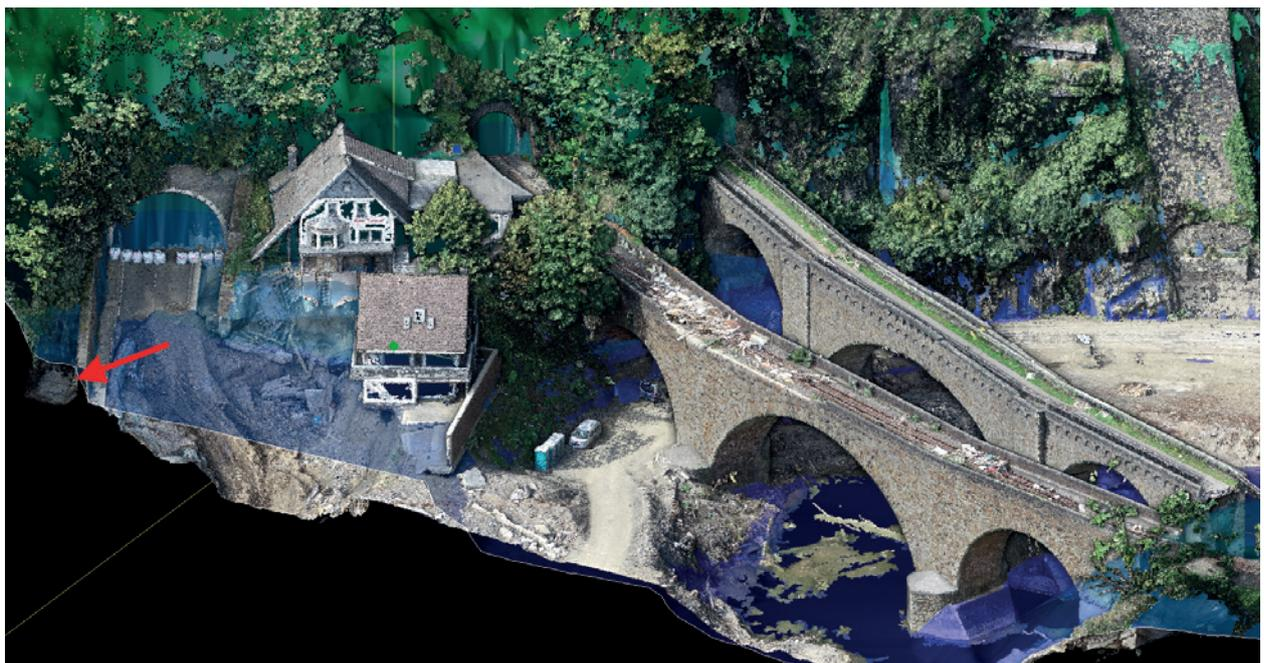
Abb. 14 | Durchdringung der eigenen Punktwolke nach der Flut mit LiDAR-Grunddaten des LVerGeo RLP (blau) aus dem Jahr 2018 /Bild: M. Petry/
