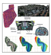
Oben: Gezeigt ist das Ergebnis der Befliegung mit einer DJI Matrice 300 RTK zum einen die Thermalaufnahme (links) und zum anderen die 3D-Punktwolke (rechts) für ein Stadtquartier (Soot et al.)
