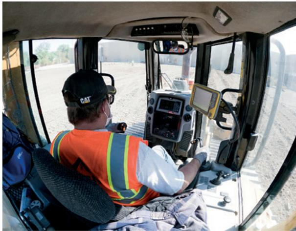
Die Lösung MC-Max umfasst flexible Anbaulösungen sowie optionale automatische Schild-, Schaufel- und Löffelsteuerung für eine Vielzahl von Maschinen. Das System bietet außerdem eine ganze Reihe von Positionierungstechnologien, von der Neigungskontrolle über Lasersteuerung bis hin zu echten 3D-Anwendungen mittels GNSS-Systemen, welche alle verfügbaren Satellitensysteme nutzen, Robotik-Totalstation und Millimeter-GPS-Systemen.
