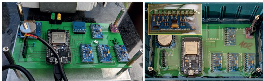
Abb. 13 | Links: Sensormodul, Sensoren von links nach rechts: RTC Echtzeitzuhrensensoren, LED-Status sowie Mikrocontroller ESP32, SD-Card Shield für die Datensicherung, 4 x MPU-9250, 1x BME280 (lila). Rechts: Sensormodul 102 in einer Zwei-Komponenten-Vollgussmasse eingebunden. Schwarze Sensorgehäuse der MPU-9250 sind nun mit den blauen und der grünen Platine verbunden.
