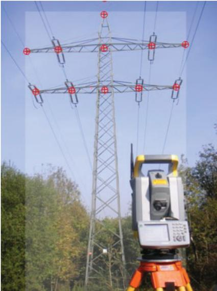
*Abb. 7: Mastaufnahme, Punkte, vertikale Ebene*
