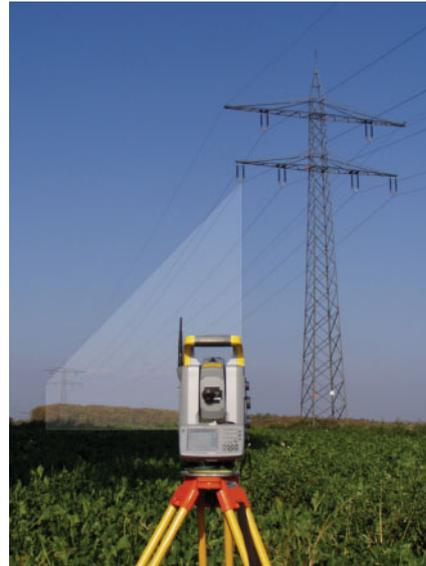
*Abb. 8: Durchhangmessung, vertikale Ebene*
