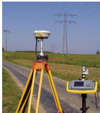
Abb. 1: Trimble R8 GPS-System
