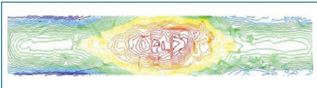
Abb. 11 neu: Differenzplananalyse der Tragwerksunterseite (Trogboden) – Isoliniendarstellung
