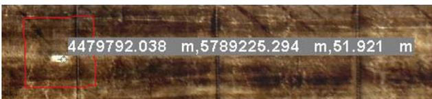
Abb. 13: Beispiel für die Lokalisierung einer möglichen Schadstelle
