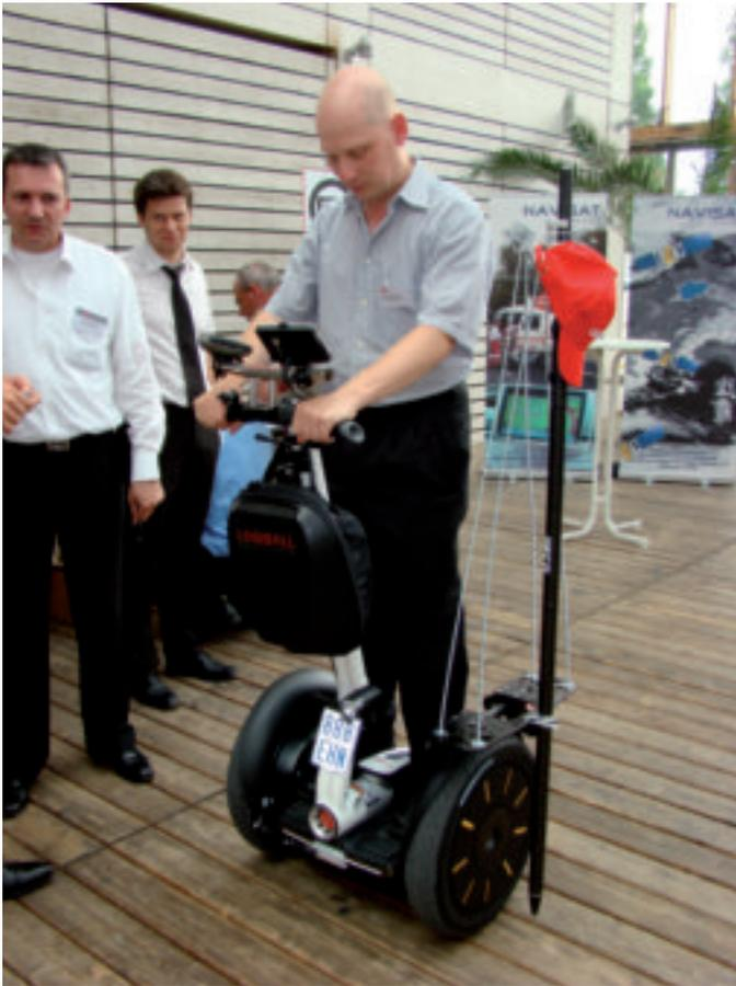
*Segway mit Antennenstab für professionelle GPS-Koordinatenmessung: Eine Möglichkeit, Geoinformationen für die Fußgängernavigation zu sammeln. // Segway with antenna rod for professional GPS co-ordinate measurements: one possible way of compiling geoinformation for pedestrian navigation. Photo: Thalmann.*
