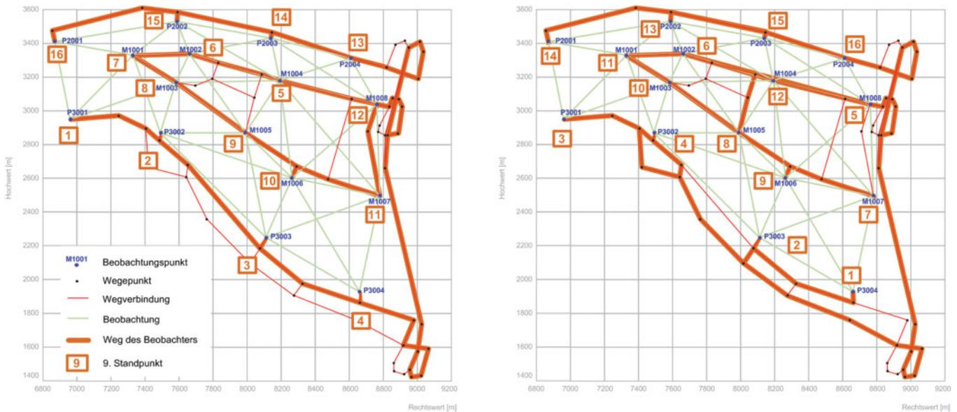
Abb. 12: Vergleich zwischen der kürzesten Route (links) und der ermittelten besten Route (rechts) zwischen den Standpunkten
