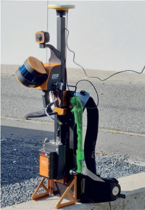
Abb. 2: Einsatzbereiter Rucksack-Scanner mit Scanner, Panoramakamera und GPS
