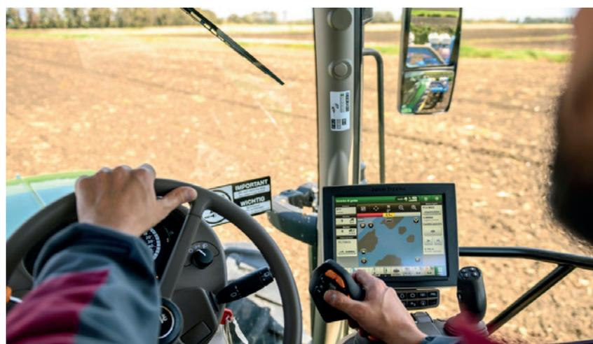
Cockpit im Führerhaus einer Saatmaschine mit Ertragszonenkarte
