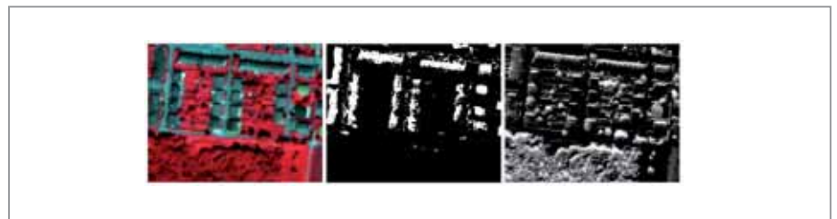
Abb. 3: Satellitenbild mit Trainingsgebieten (links), Funktion Single Feature Probability: potenzielle Häuser hell dargestellt (Mitte), Funktion Shadow: potenzielle Schattengebiete hell dargestellt (rechts).
