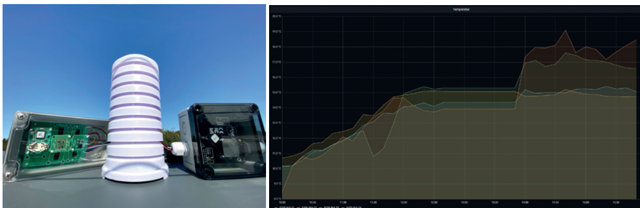
Abb. 7 | Mobile Senseboxen (links) mit gemessenen Temperaturverläufen während der Messkampagne (rechts)
