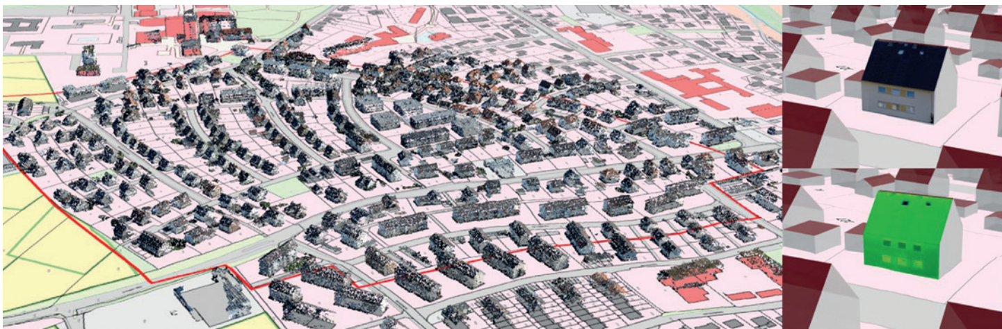
Abb. 9 | Datenaggregation im GIS mit segmentierter Punktwolke (links), texturiertes Gebäudemodell (rechts)
