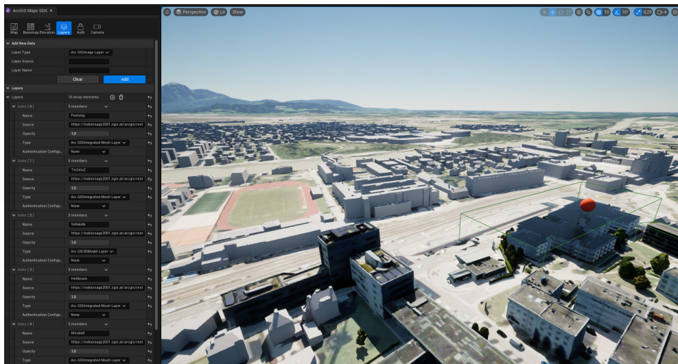
Abb. 2: ArcGIS Maps SDK for Unreal Engine zur Integration räumlicher Daten (hier eine Grundkarte, einfache LOD1-Gebäudeblöcke und -Gebäudemeshes)
