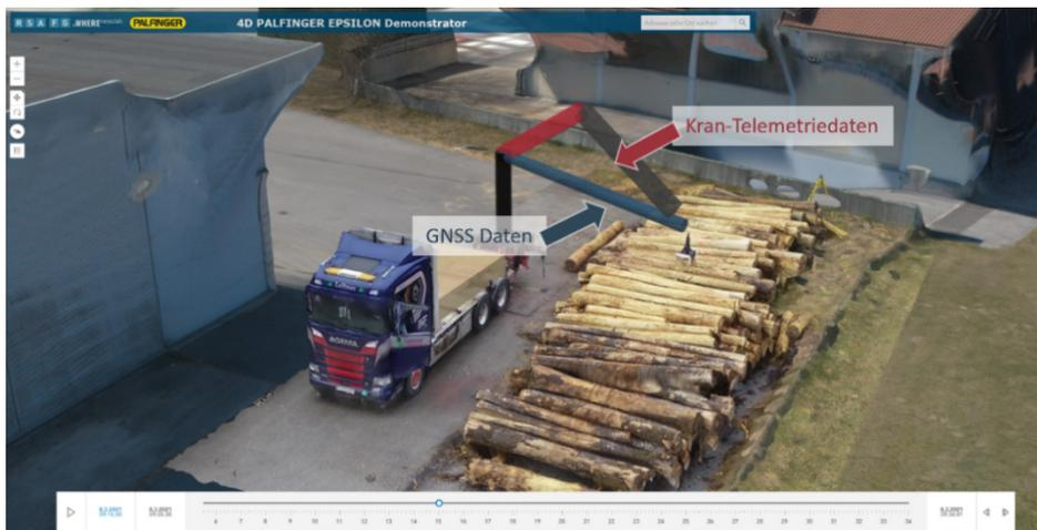
**Abb. 3:** Prototypische 4D-Krandatensimulation als interaktive Webkarte mit Zeitschieberegler (nach zweitem Ladevorgang mit GNSS-Krandaten und Kran-Telemetriedaten im Vergleich)
