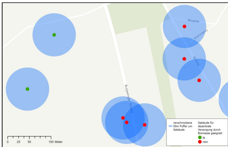
Abb. 3: Entscheidung über Dezentralität durch Pufferung
