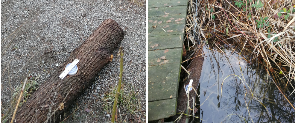
Abb. 3: Sensorplattform im Baumstamm (links); zudem im Wasser schwimmend (rechts)
