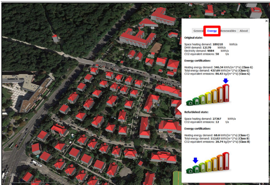
Abb. 3: 3D-Visualisierung von gebäudescharfen Energiekennzahlen, sowie Vergleich des Status quo mit einem Sanierungsszenario
