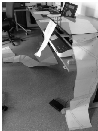
Abb. 2: Digitalisierung von Überformaten am Bookeye 4
