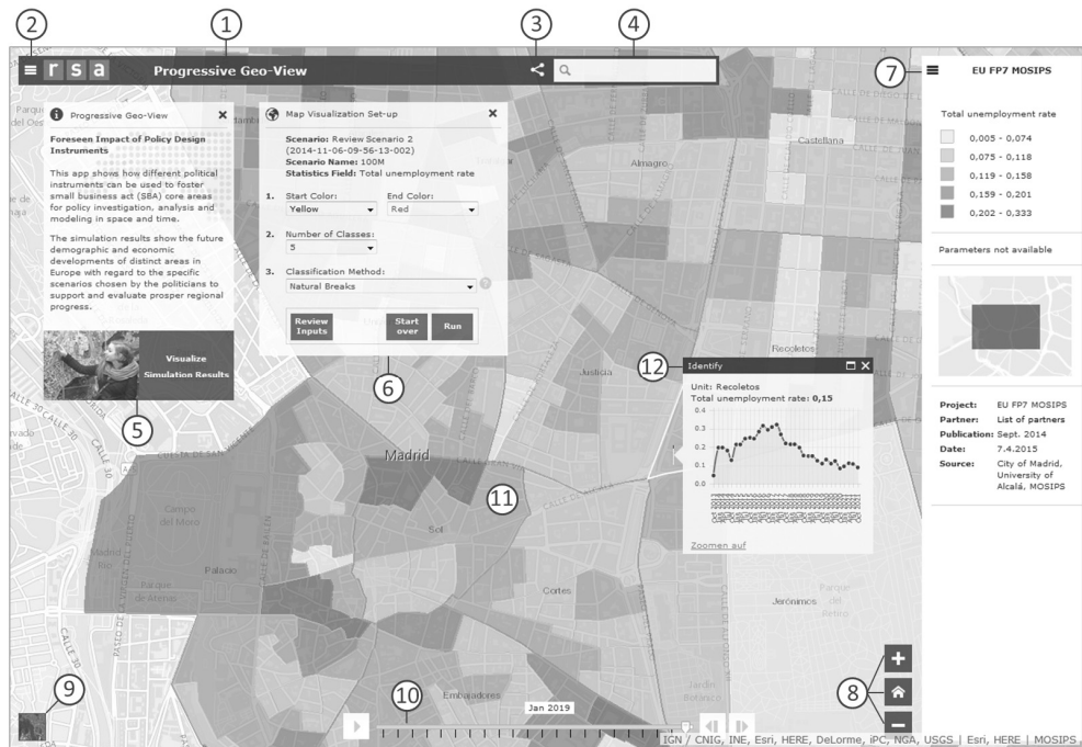
Abb. 3: Dynamische Webkarte: „Header“ (1), „Einstellungen öffnen“ (2), „Webkarte teilen“ (3), „Adresssuche“ (4), „Info-Fenster“ (5), „Wizard-Fenster“ (6), „Legendenmenü“ (7), „Navigations-Buttons“ (8), „Hintergrundkarte ändern“ (9), „Zeitschieberegler“ (10), „Kartenlayer“ (11) und „Identify-Fenster“ (12)
