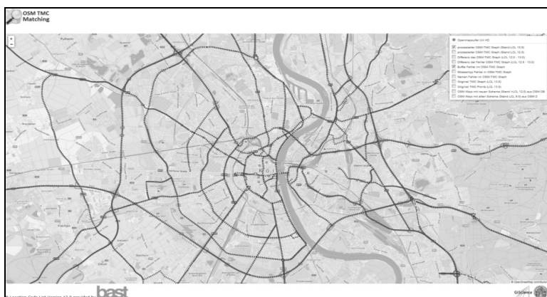
Abb. 2: Erstellter TMC-OSM-Graph als Overlay am Beispiel für Köln (grüne Linien = TMC-OSM-Graph und rote Linien = Probleme beim Matching)
