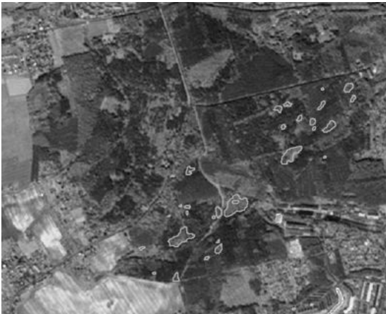
Abb. 2: Tornadoschäden westlich der Stadt Gera, erfasst mithilfe von RapidEye (© RAPIDEYE (2012); PROVIDED UNDER EC/ESA GSC-DA)
