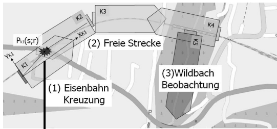
Abb. 2: Beispiel für Sensorpositionen im Feld
