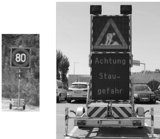
Abb. 5: Verschiedene Anzeigetafeln (links eine kleine mit begrenzten Möglichkeiten, rechts zwei separate Anzeigen plus Warnlicht)
