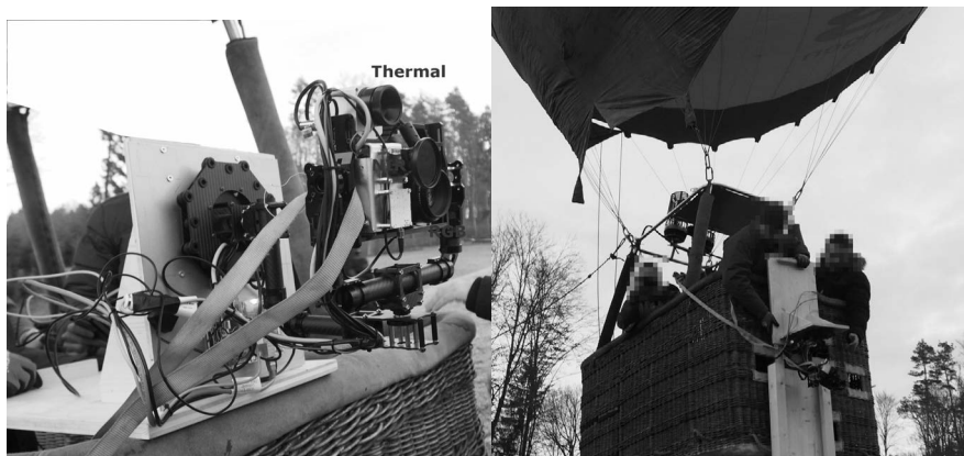
Abb. 1: Aufbau des Kamerakopfes (links) und Anbringung am Ballon (rechts)
