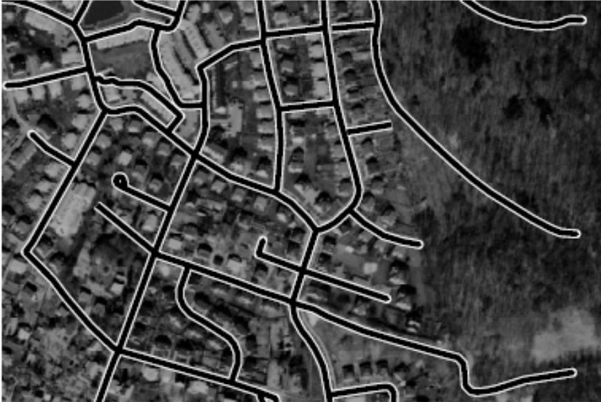
**Abb. 6:** Ein fusionierter optimaler Straßenvektordatensatz mit hochauflösendem *HRSC-A*-Bild im Hintergrund (Potsdam)
