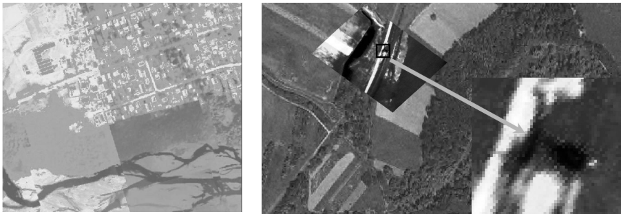
Abb. 3: Thermalbild (links) in wolkenbedecktem Aufnahmebereich; Dammdurchnässung (rechts)
