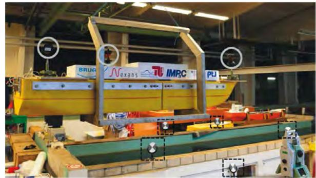
Abb. 5 | Modellschiff mit montierten Prismen (Kreise) und Zielmarken (gestrichelte Rechtecke) zur Transformation in ein gemeinsames Koordinatensystem
