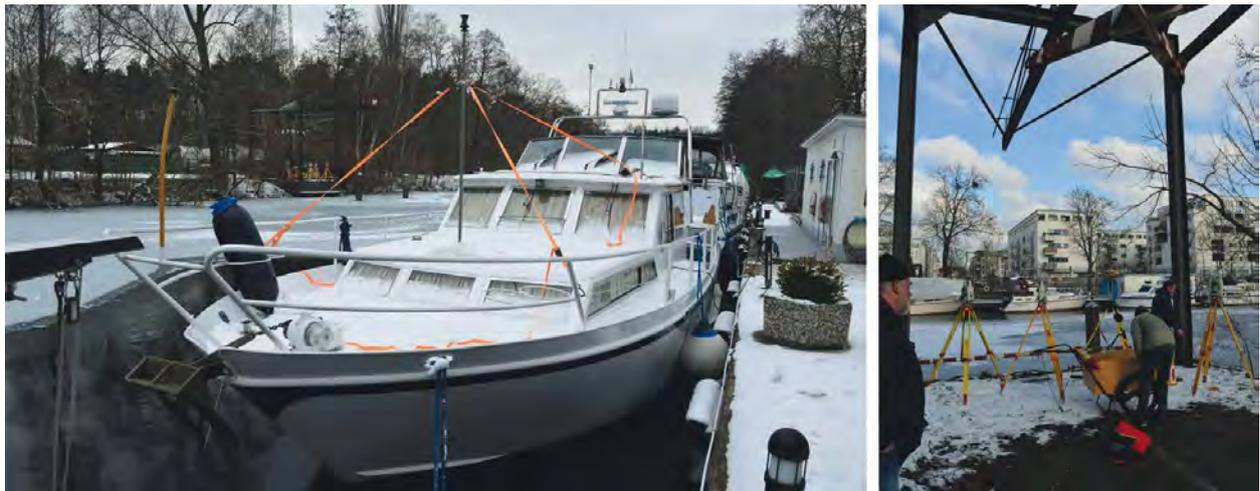
Abb. 8 | Das mit Prismen bestückte Schiff (links) sowie die Messinstrumente (rechts)
