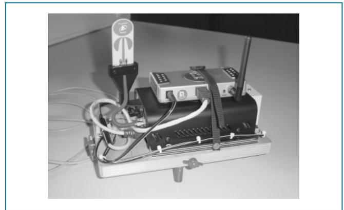
Abb. 5: UWB-Transceiver mit aufgesetzter WLAN-Bridge
