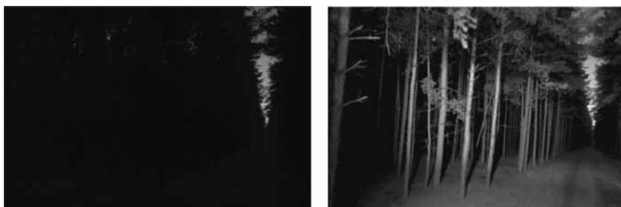
Abb. 8: Kameraaufnahmen bei 100 lx Tageslicht ohne (links) und mit Flash (rechts)
