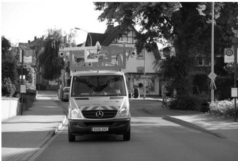
Abb. 4 und 5: Die kinematische Erfassung erfolgte mit hochauflösenden Mess- und Videokameras des Systems „eagle eye technologies“ in einer absoluten Genauigkeit unter 10 cm.
