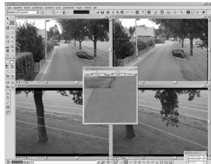
Abb. 4 und 5: Die kinematische Erfassung erfolgte mit hochauflösenden Mess- und Videokameras des Systems „eagle eye technologies“ in einer absoluten Genauigkeit unter 10 cm.
