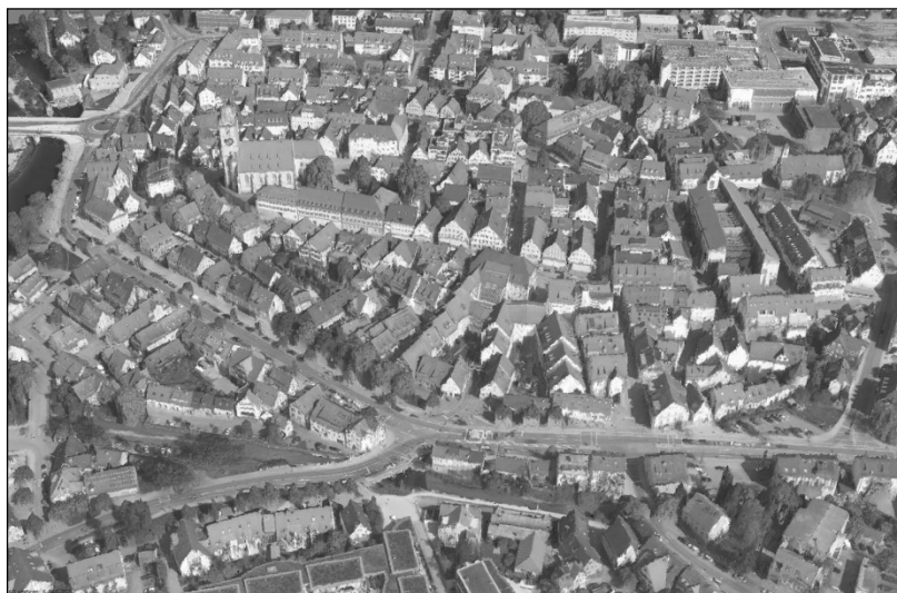
Abb. 1: Rendering des hochauflösenden Oberflächenmodells, das als Haupt-Datengrundlage für die Solarpotenzialanalyse verwendet wurde
