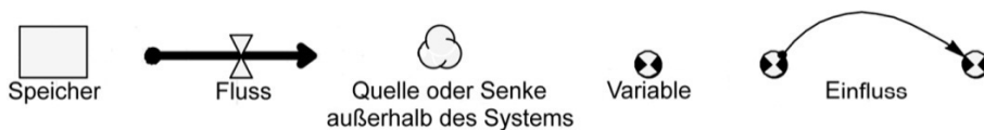
Abb. 1: Komponenten des System Dynamics Ansatzes am Beispiel der Software SIMILE (MUETZELFELDT & MASSHEDER 2003)
