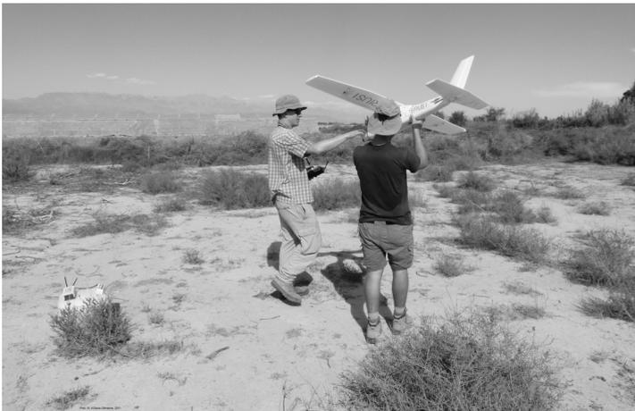
**Abb. 2:** Startbereites UAS kurz vor einer Luftbildbefliegung sowie Kommunikationseinheit zwischen UAS und Laptop im linken Teil des Fotos (Foto: W. d'Oleire-Oltmanns, 2011)
