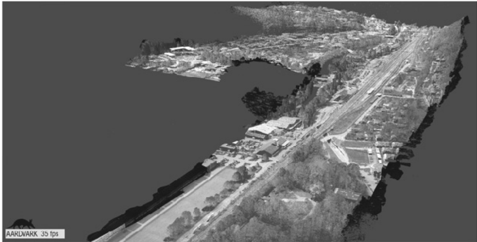
Abb. 3: Punktwolke mit rund 50 Mio. Laserscanpunkten
